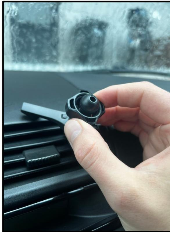
6. Schieben Sie die Rückseite der Halterung mit der magnetischen Fläche in die Kunststoffmutter, und schrauben Sie die Mutter fest, bis die Verbindung fest sitzt.
