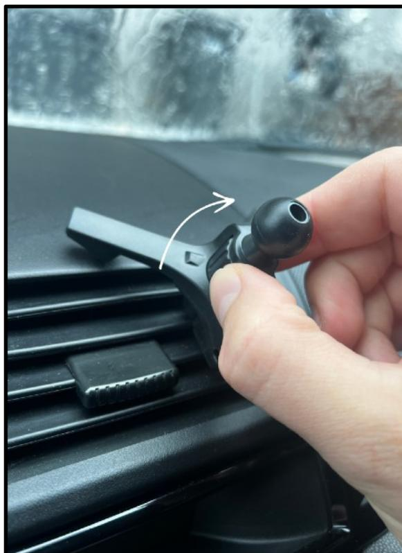
5. Setzen Sie die Kunststoffmutter auf die Vorderseite der Halterung.
